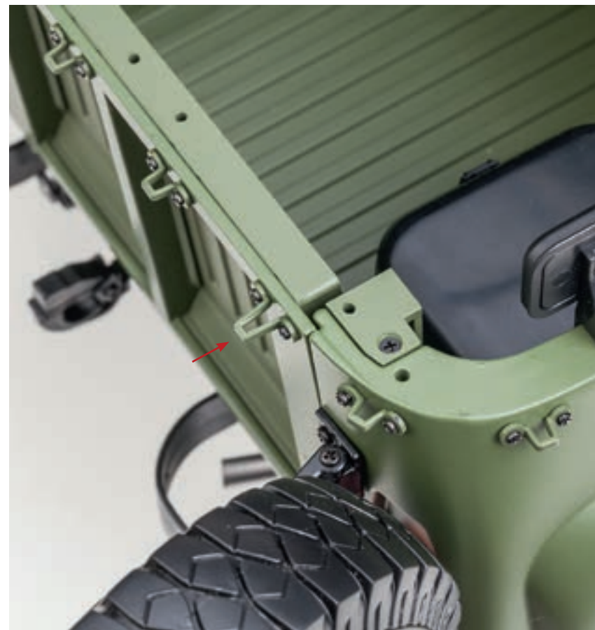
Шаг 4. Установите две высокие скобы крепления тента в верхних углах откидного борта кузова. Для крепления скоб используйте четыре винта 1,5×3 (RM).
