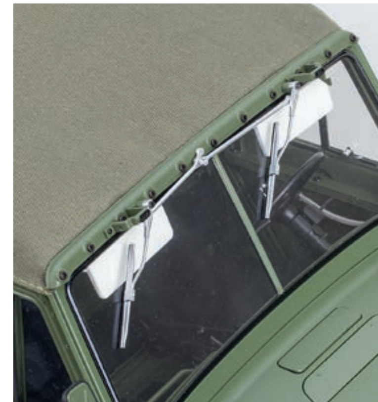
Шаг 6. Совместите отверстия в передней части тента с отверстиями рамки ветрового окна. Заново закрепите планку сквозь тент на рамке ветрового окна одиннадцатью винтами 1,7×4 (CM).
