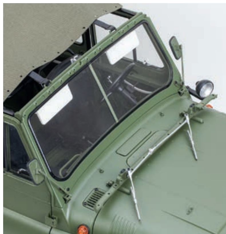
Шаг 5. Разместите тент на модели поверх каркаса. Демонтируйте верхнюю планку ветрового окна вместе с механизмом стеклоочистителей. Для этого открутите одиннадцать винтов, удерживающих планку на рамке.
